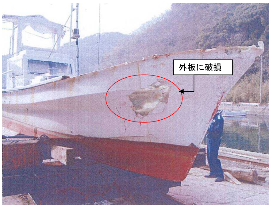
写真2 B 船損傷部
