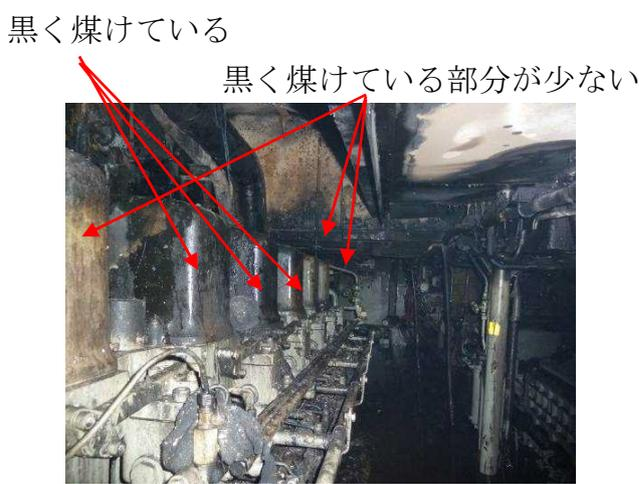
写真② 主機左舷側シリンダヘッドカバー
