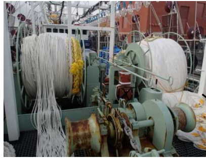
写真1 船首甲板両舷側に装備されたリールウインチ
