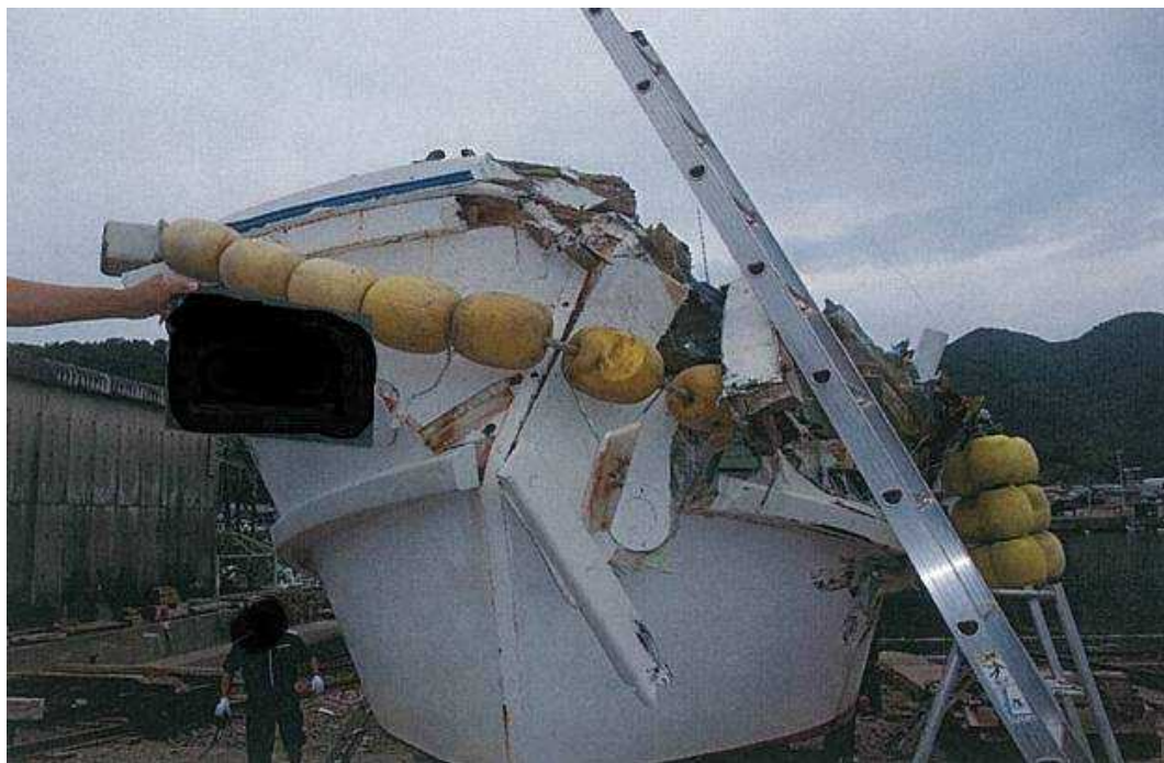
写真4 B船の損傷状況（船首部）
