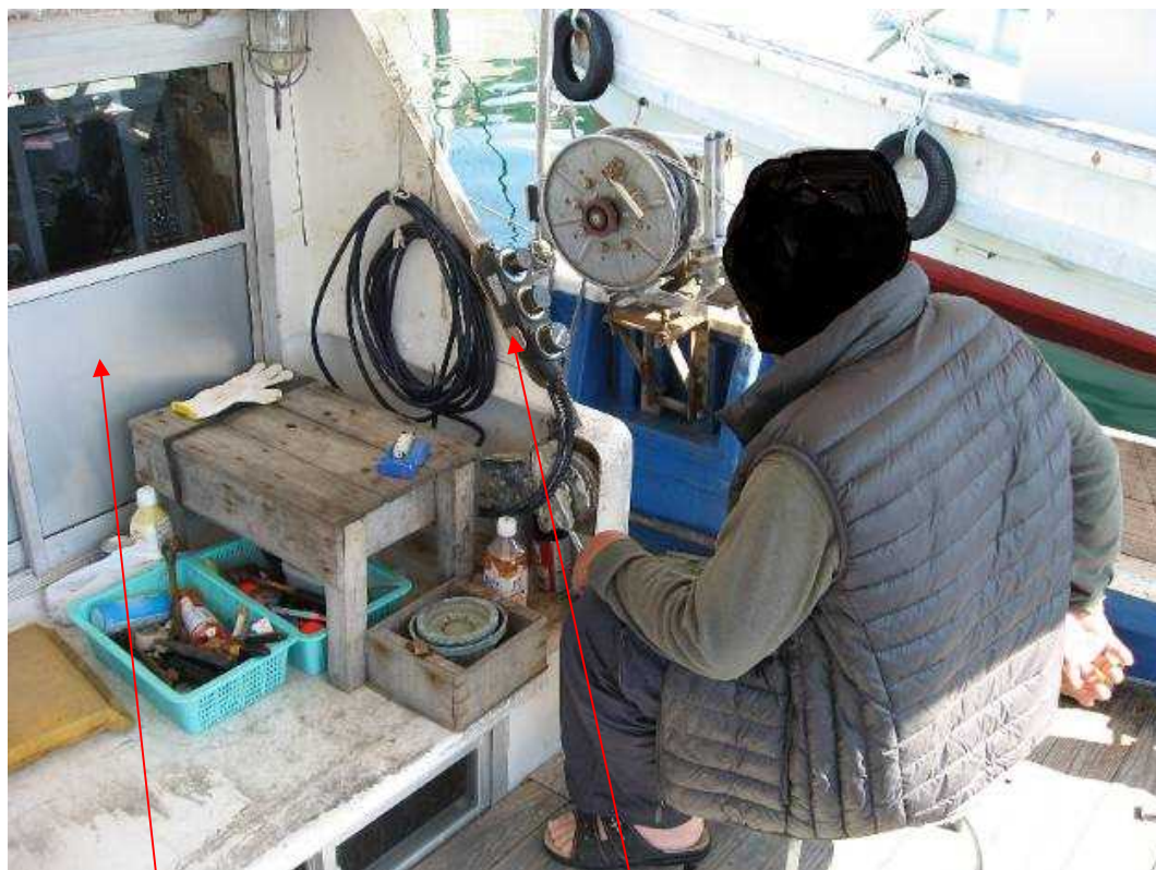
操縦用リモートコントロール装置 操舵室への出入口（引き戸近くに GPS プロッター及びレーダーが設置）
