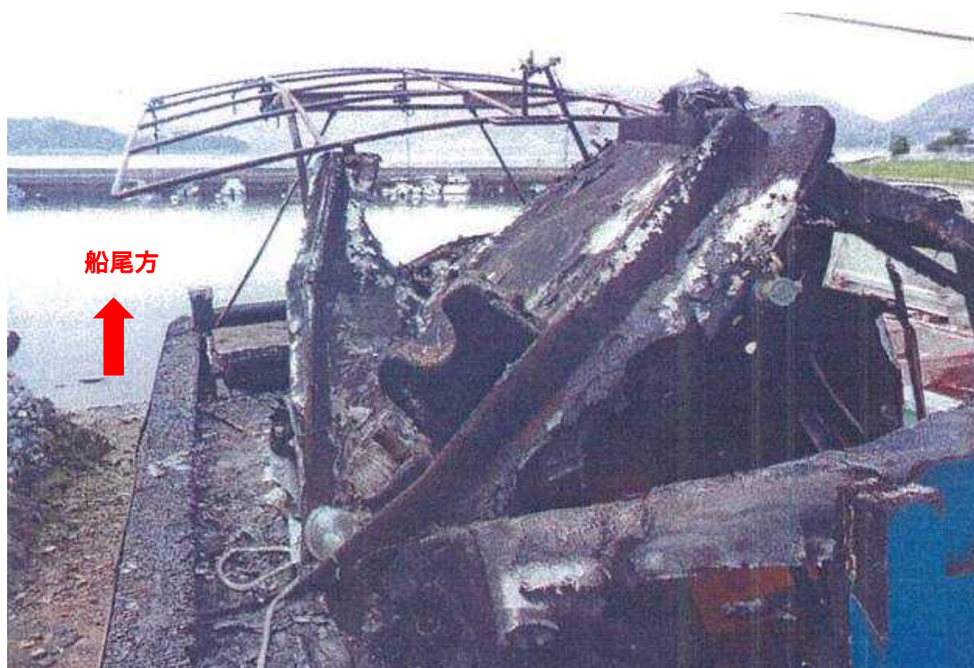
写真2 操舵室及び機関室の焼損状況
