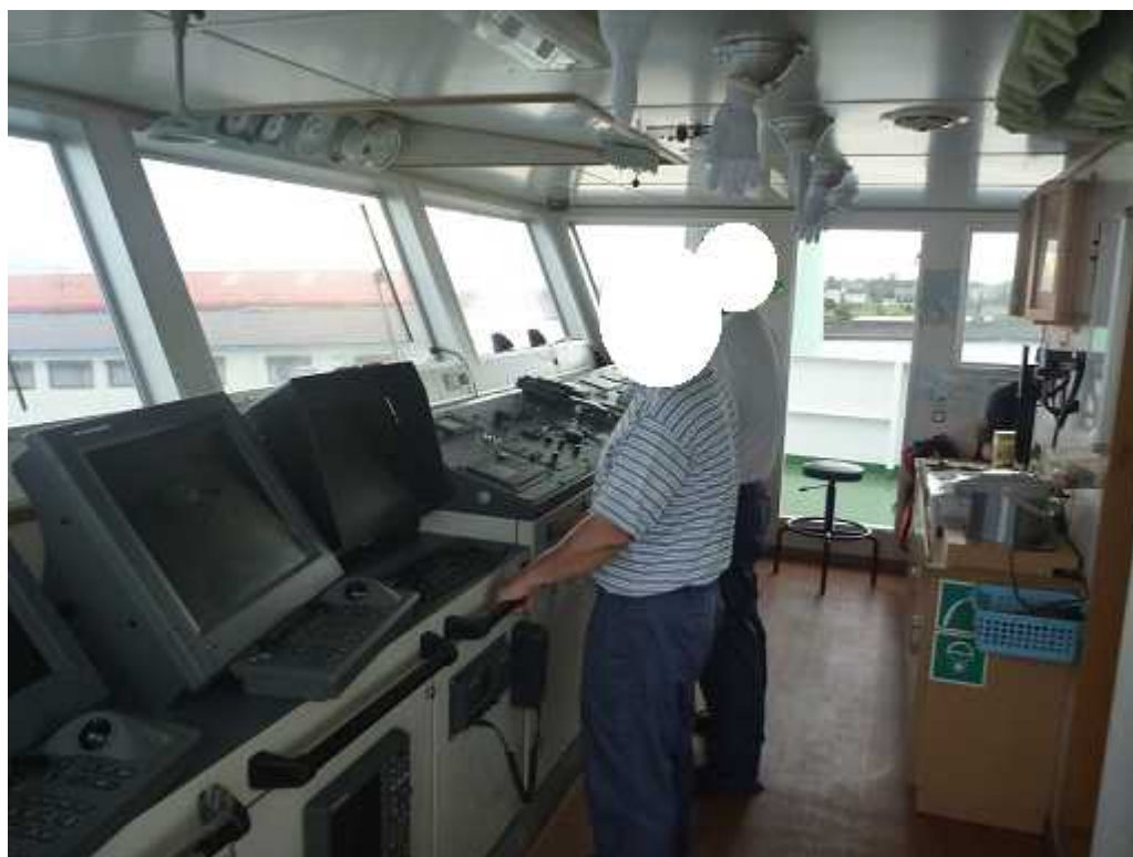
写真5 船橋内の機器配置及び当直位置
