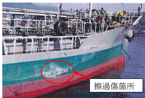
写真3 右舷外板損傷状況②
