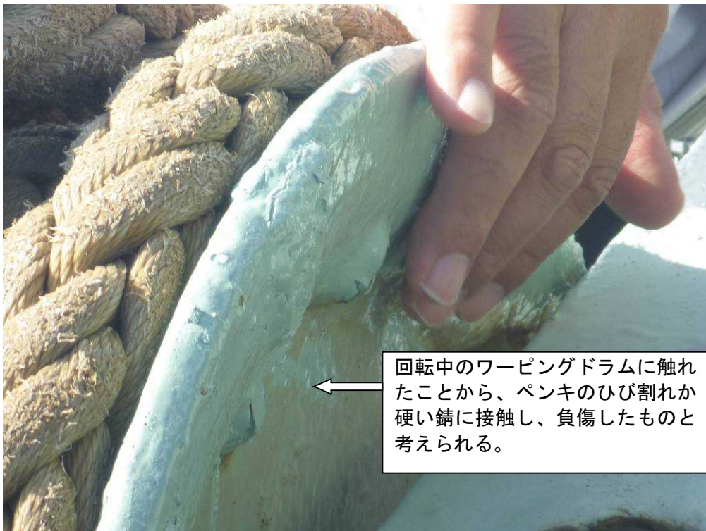
写真2 ワーピングドラムの事故発生箇所拡大写真
