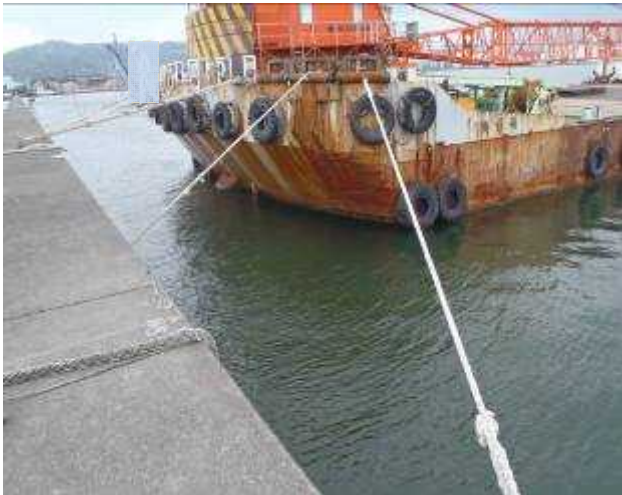
写真1 B船船首部係留索の状況（本事故時、渡り板はなく、船尾方に後退していた。）
