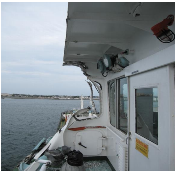
写真7 B船の船橋左舷ウイングの損傷状況②
