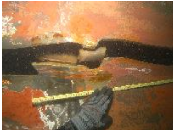
写真6 B船の左舷後部水線下の破口
