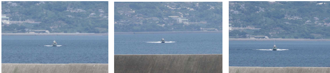
写真2.11-2 B船の同型船の白波（左から、針路約260°速力約12kn、針路約265°速力約16kn、針路約260°速力約20kn）
