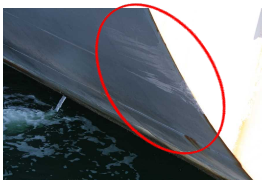
写真2.3-2 左舷船尾部の擦過傷
