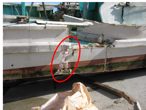
写真2.3-3 B船の損傷状況(拡大)
