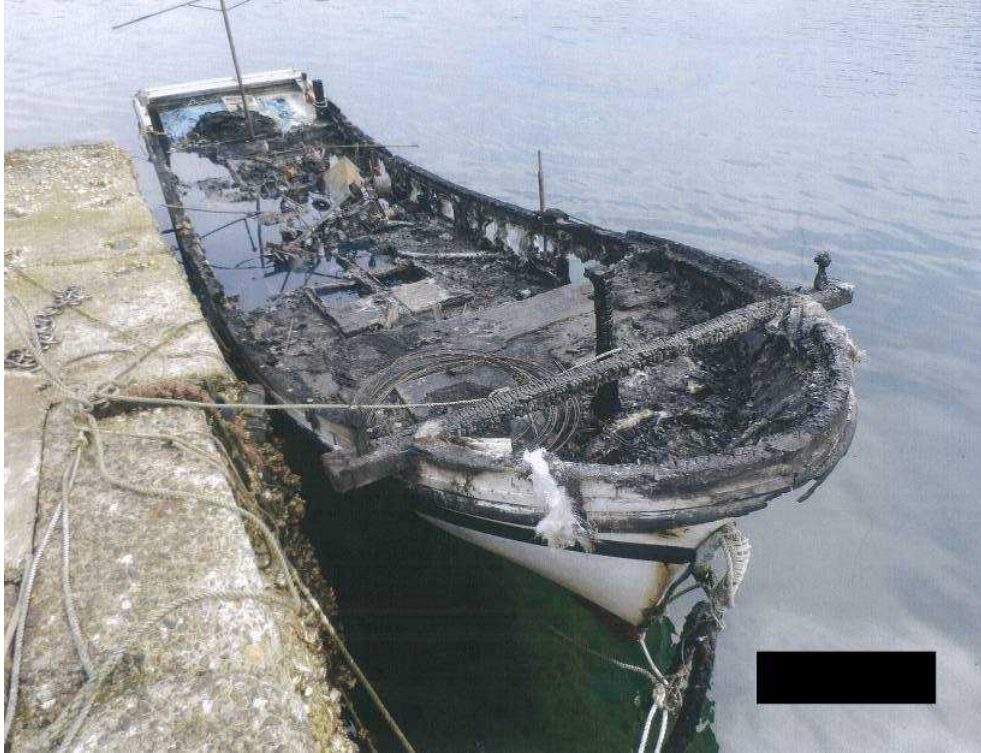
写真1 本船の焼損状況
