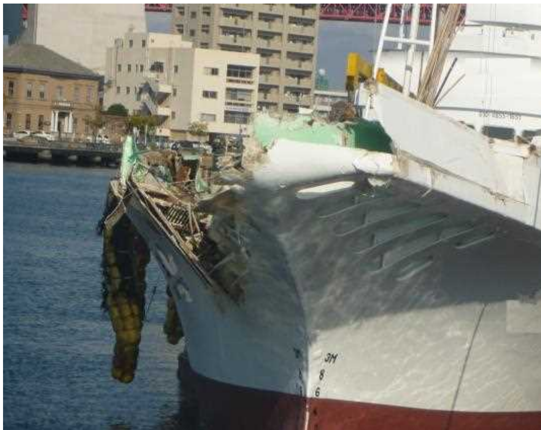
写真2 B船船首損傷部（外板）
