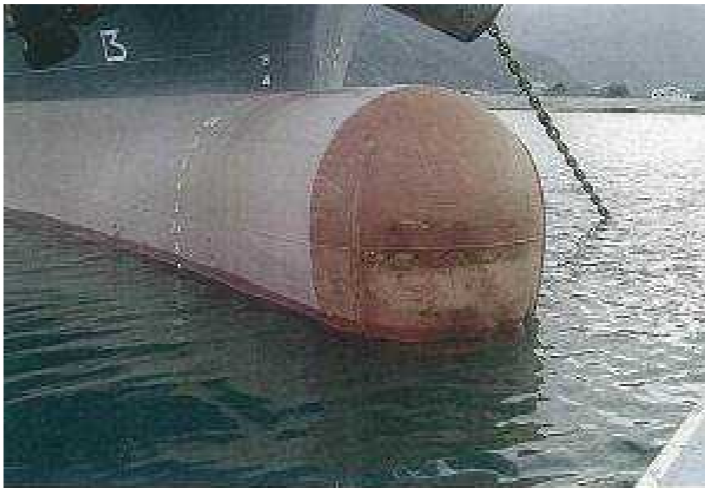
写真1 A船球状船首部損傷状況
