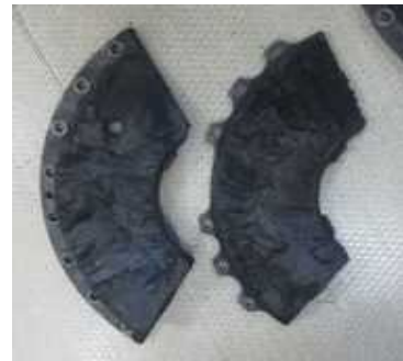
写真3 本件継ぎ手の取付位置 写真4 破断して2分割した本件継ぎ手（本来一体物）
