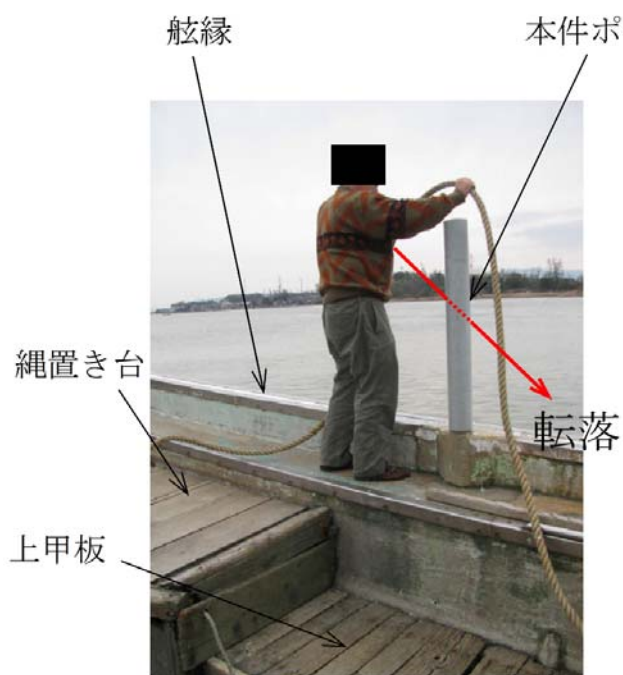
写真1 本事故発生時の 本件作業中の体勢
