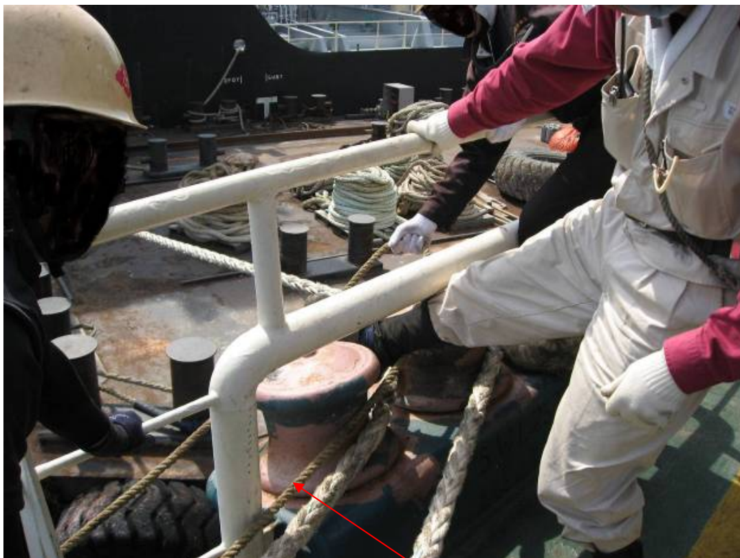
写真3 掛替え作業の再現状況
