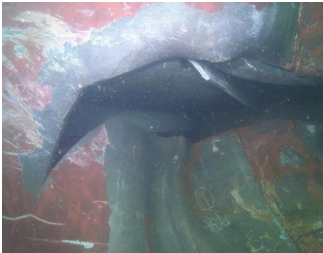
写真6 右舷船尾部に付着した本件標識灯の塗料
