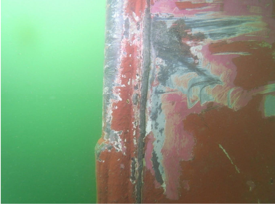
写真7 舵板の擦過傷
