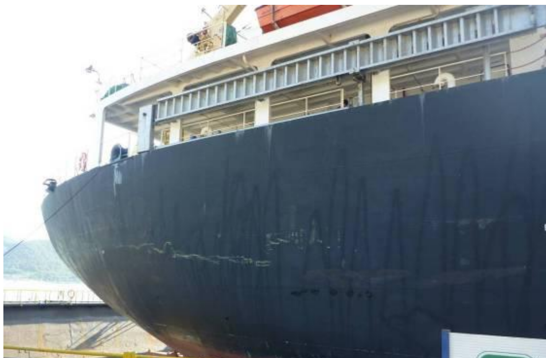
写真6 右舷船尾部に付着した本件標識灯の塗料
