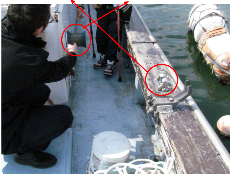
写真2 ガイドローラー及びびドラム
