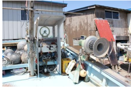
写真2 前部甲板右舷側に設置された 操舵場所及びローラー
