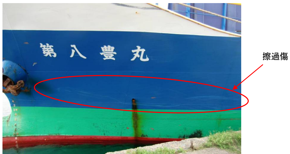
写真3 A船の損傷状況
