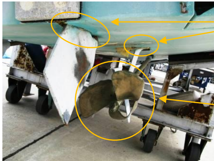
写真2 船尾船底外板及びプロペラ翼等の損傷状況（右舷）
