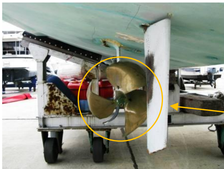
写真3 船尾船底外板及びプロペラ翼等の損傷状況（左舷）
