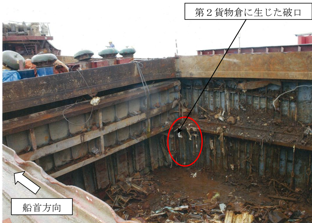
写真5 B船の損傷（その1）（引き揚げ後、破口を仮修理した状況）
