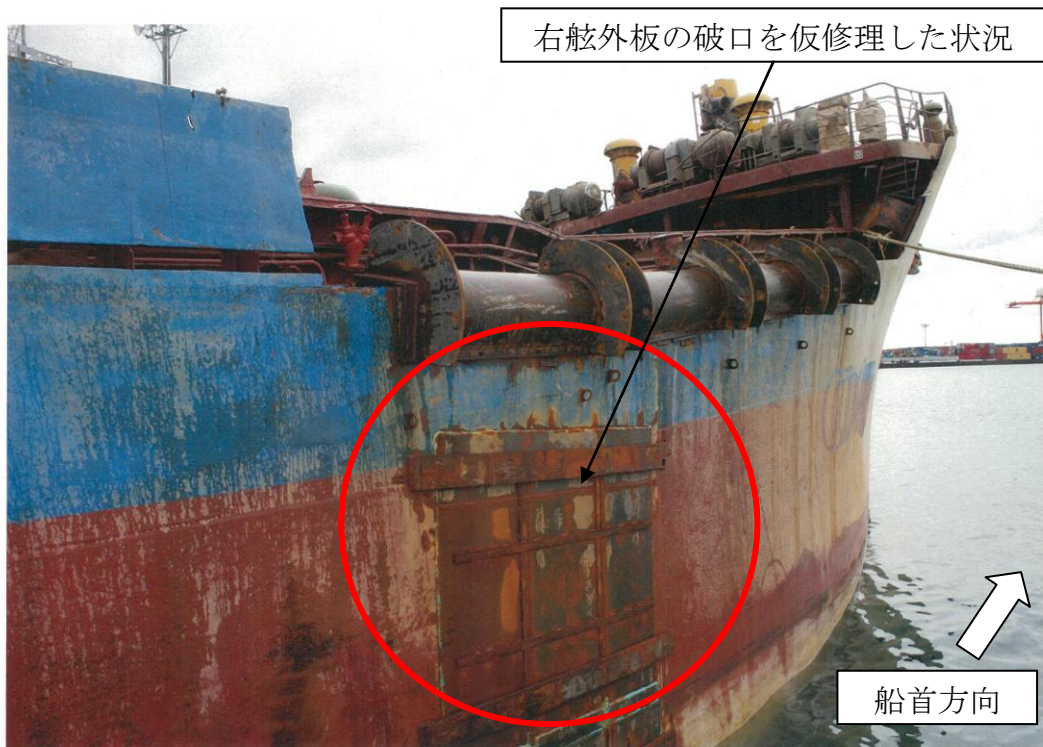
写真5 B船の損傷（その1）（引き揚げ後、破口を仮修理した状況）
