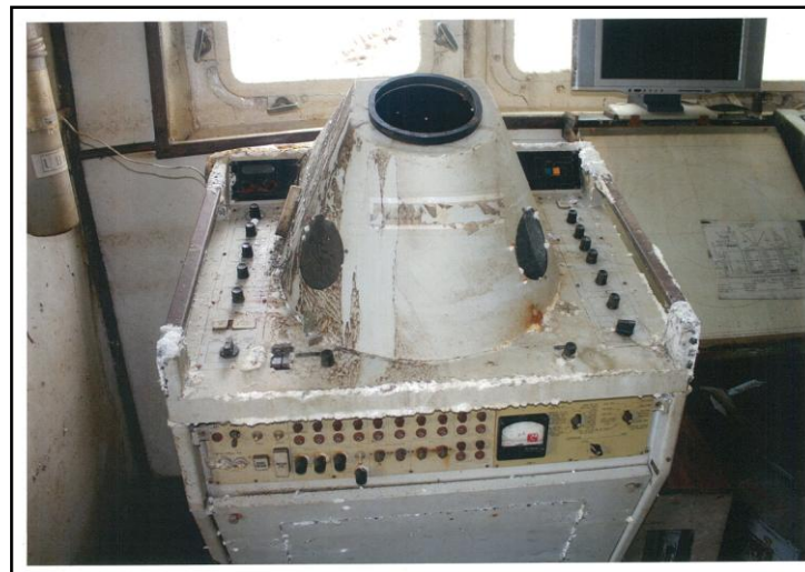
写真2.5-2 B船のレーダー（引き揚げ後の状況）
