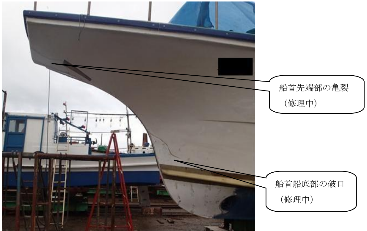
写真3 本船の損傷状況
