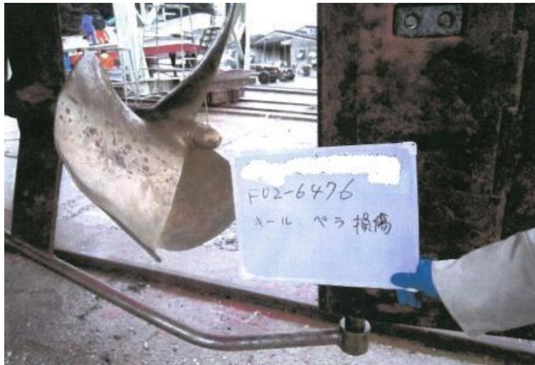
写真1 A船の損傷状況（プロペラ翼、シューピースの状況）
