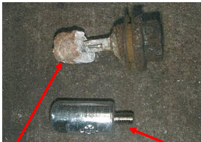
本事故後の本件防食亜鉛プラグ 新品の防食亜鉛
