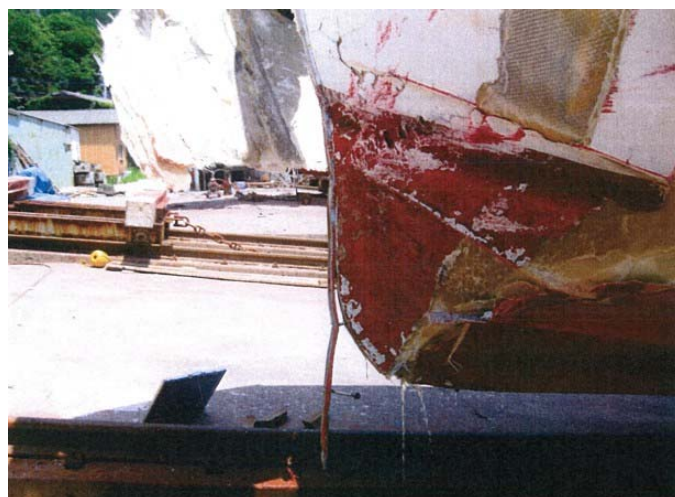
写真3 B船の損傷状況（船首部水線下）
