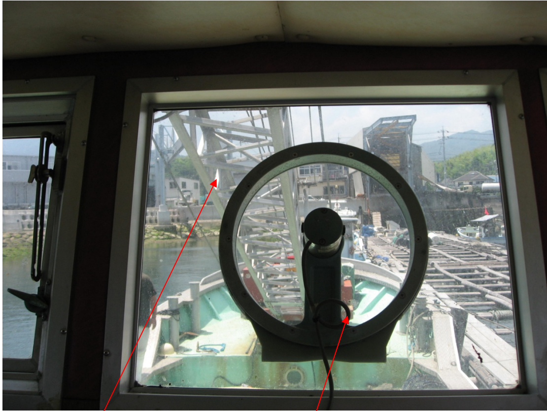
写真1 A船の操縦席からの見通し状況
