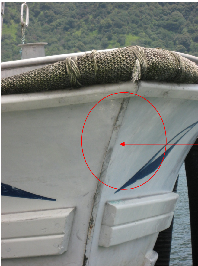
写真2 A船の損傷状況
