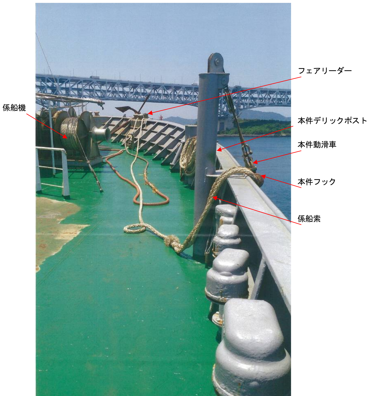
写真1 係船索の配置状況
