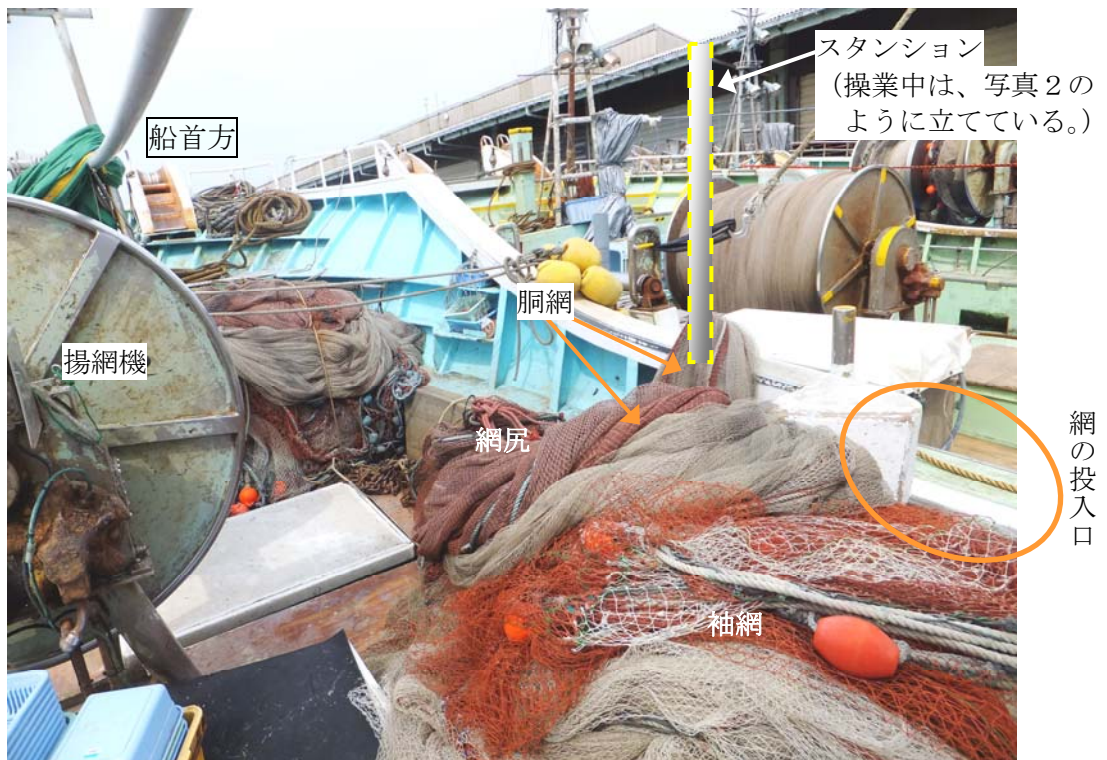
写真3 前部甲板右舷側の網の設置状況
