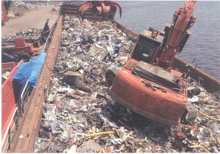
写真3 スクラップをショベルカーで圧縮している状況
