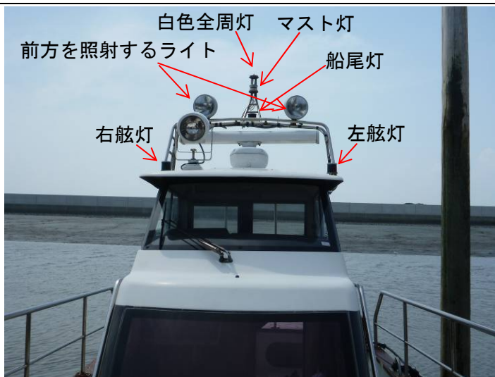
写真3 B船の灯火の状況
