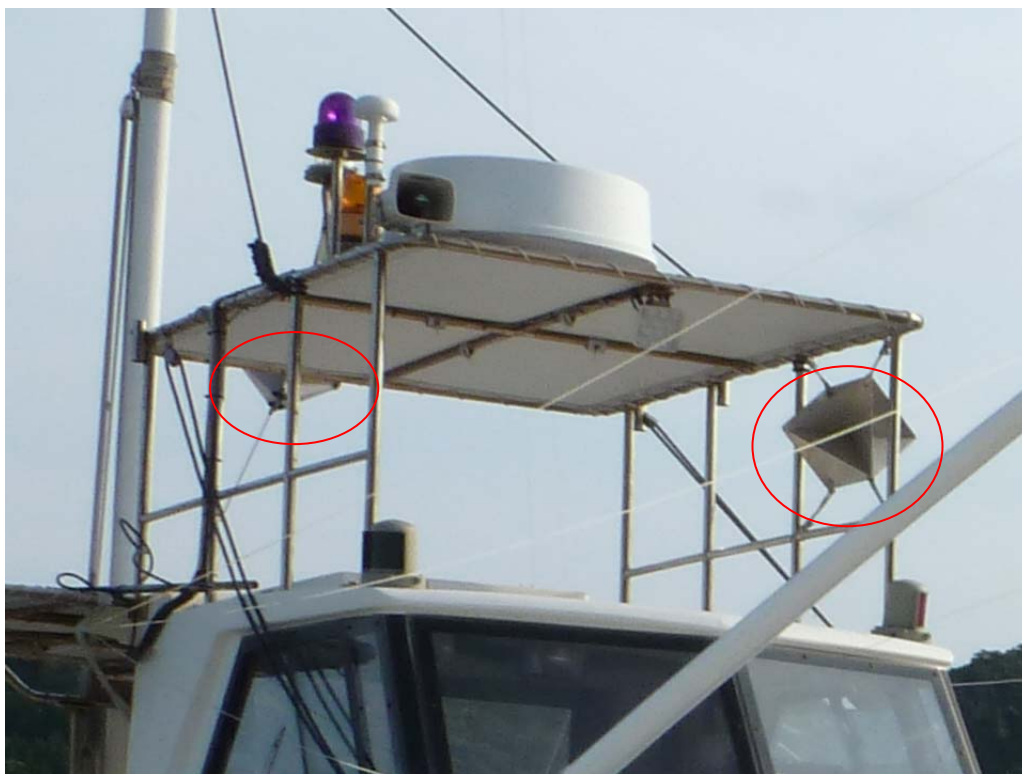
写真7 B船のレーダーリフレクタ設置状況
