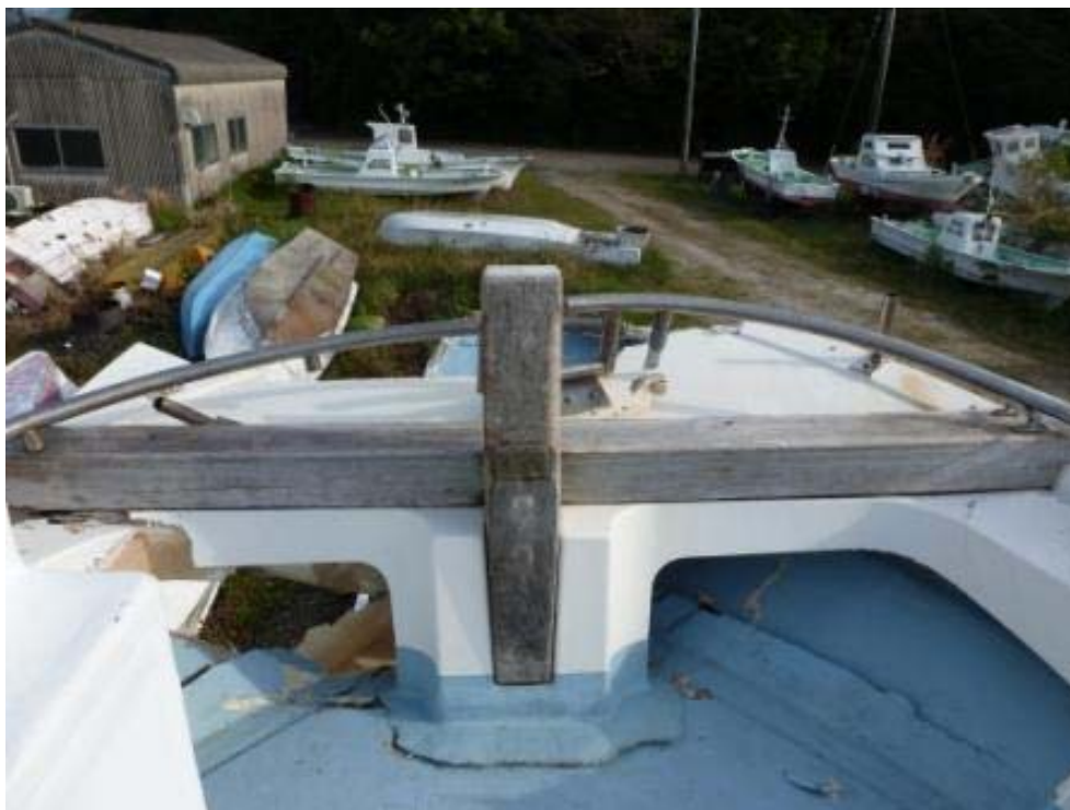
写真6 B船の損傷部位の状況（船首構造物等）
