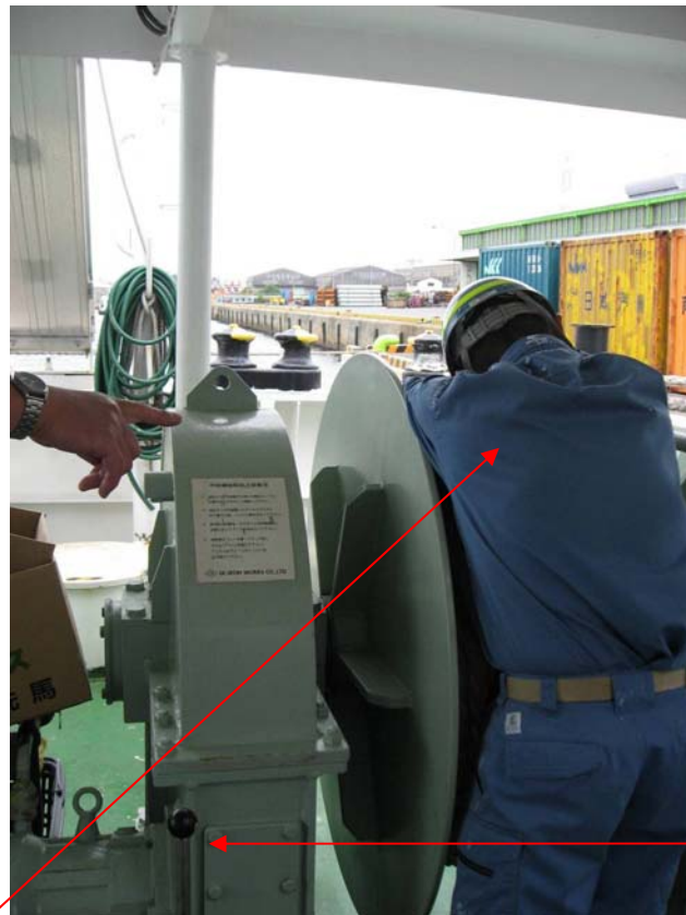
写真3 事故発生時の再現状況（後部甲板の係船装置で実施）
