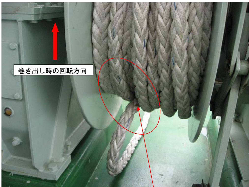
写真4 係船索のかみ込みの再現状況（後部甲板の係船装置で実施）
