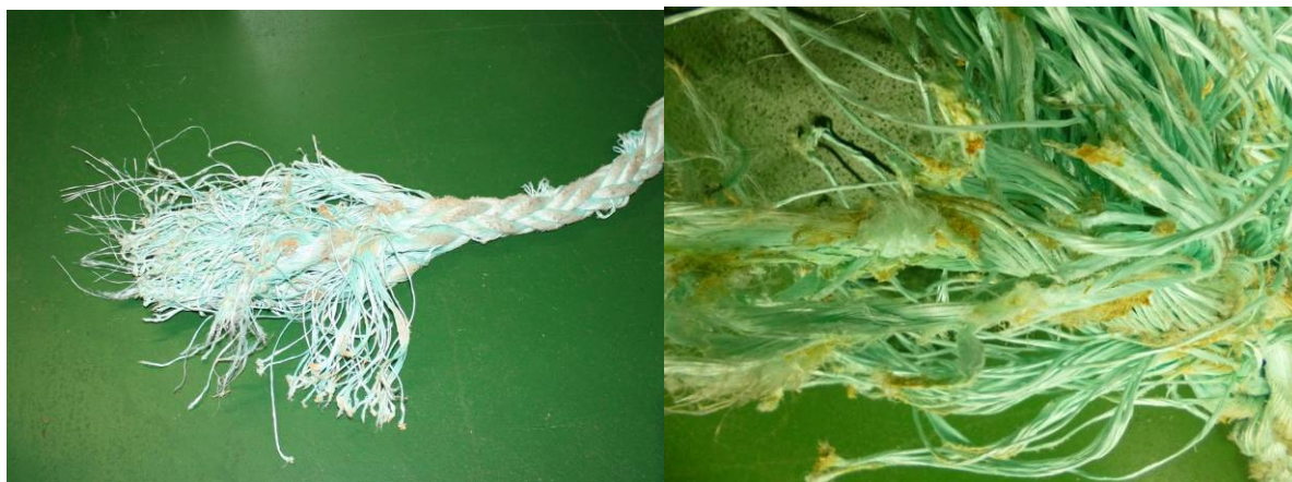
写真2-3 本件索の破断状態
