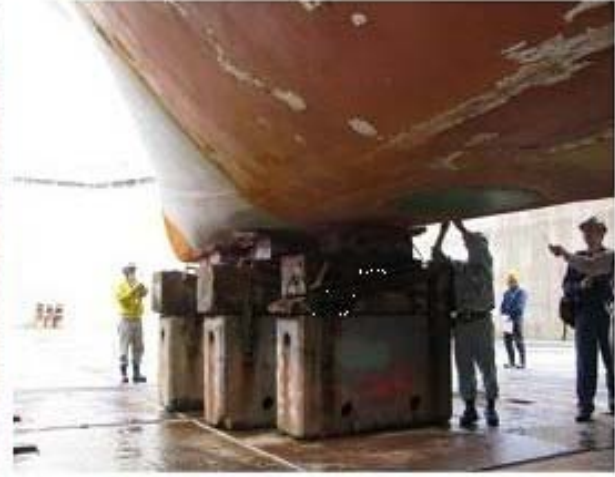
写真4 左舷前部船底部の損傷状況
