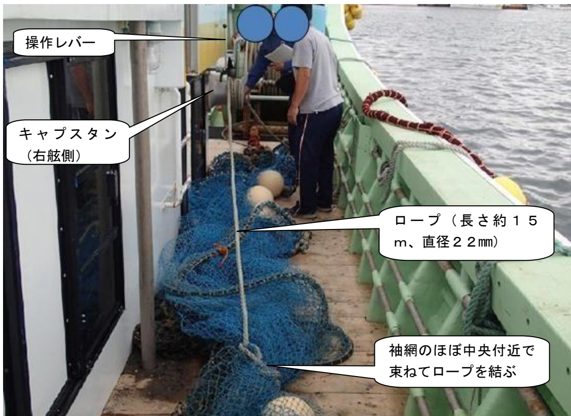
写真3 キャプスタン及びロープ
