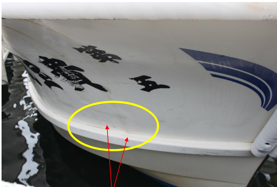
B船との衝突により付着した赤い塗料
