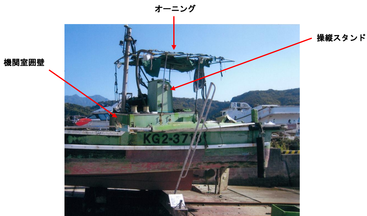
写真3 操縦場所のオーニングの損傷状況
