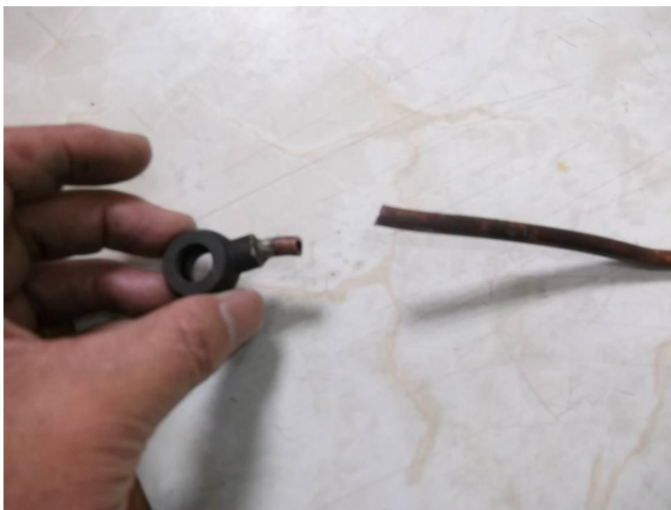
写真1 切断した燃料噴射弁の燃料油戻り管
