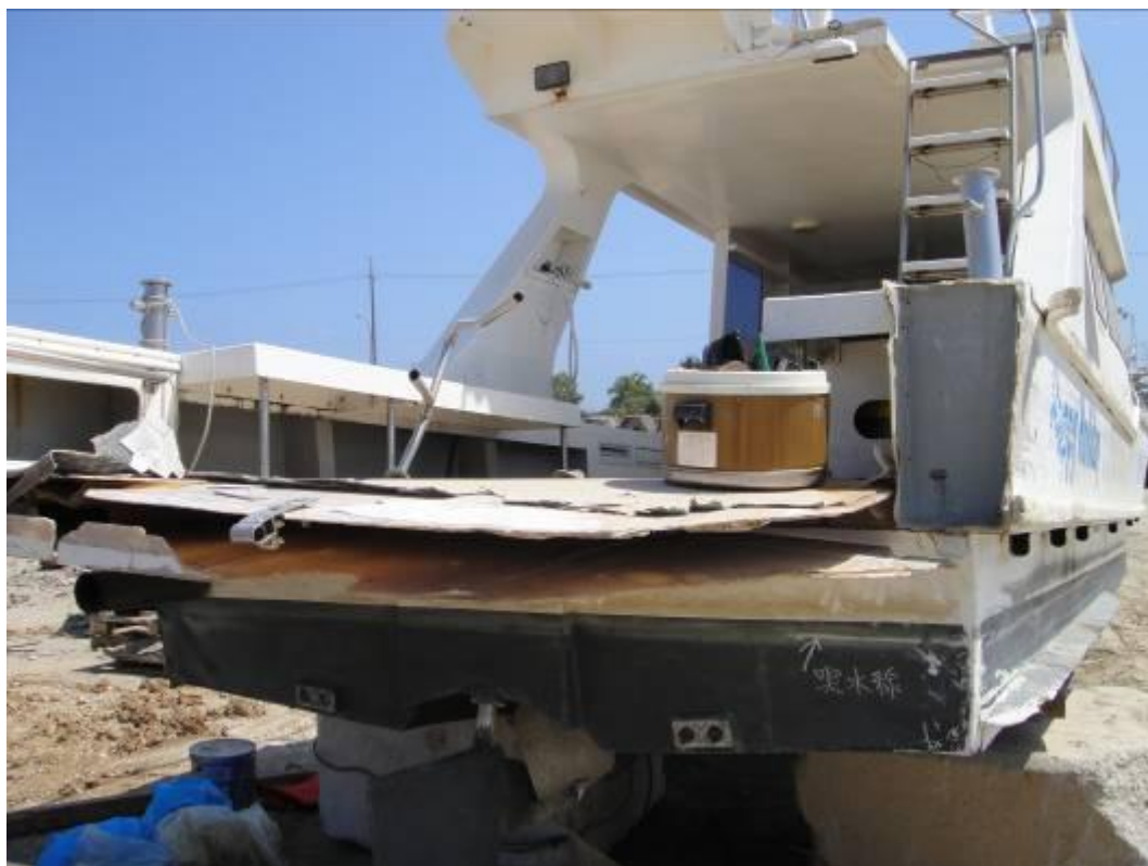
写真5 A船の漂流後の船尾の損傷状況
