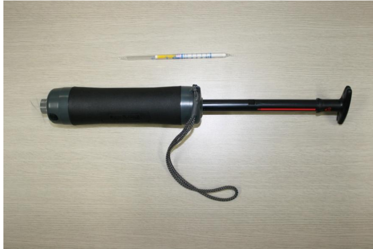
(写真 2.5-8 ガス検知装置及び検知管)
