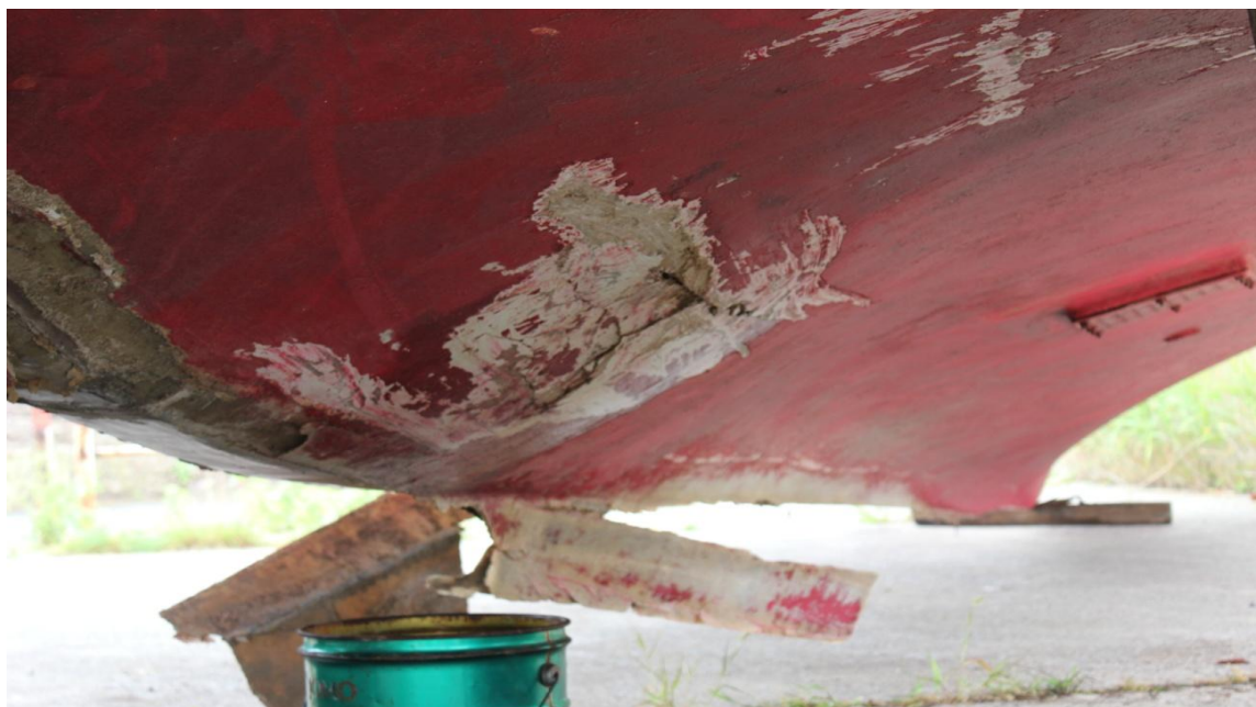
写真1 船体中央部の船底外板の損傷状況
