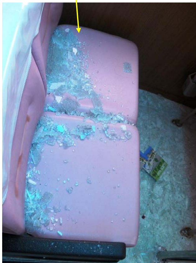
写真4 本船左舷側窓ガラスの破片
