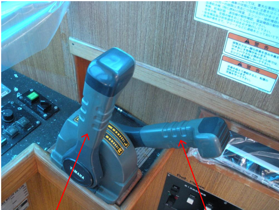
写真5 主機のクラッチ操作レバー及び燃料調整レバー
