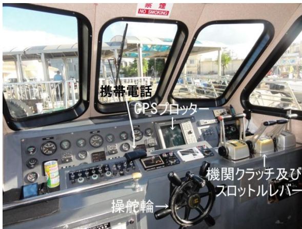
写真 2.5-8 操舵室内機器等の状況
