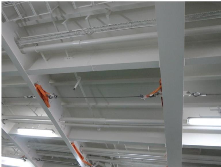
写真 2.3 オーバーラッシング用資材（車両甲板天井）
