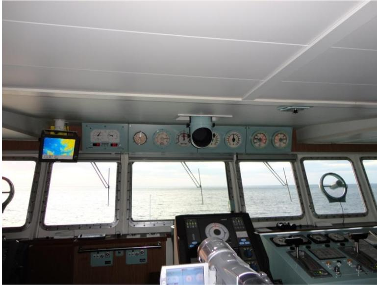
写真 2.8 船橋前壁に設置された舵角指示器等
