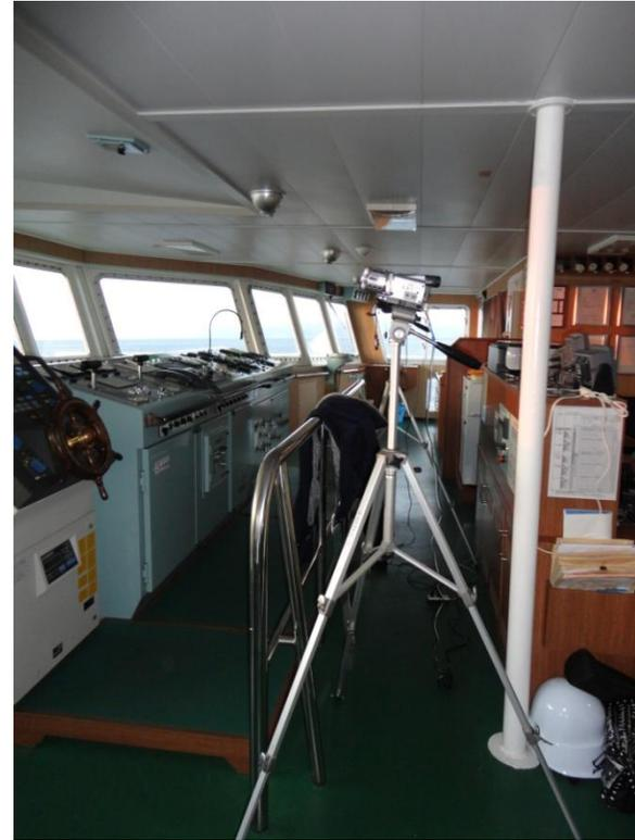
写真 2.9 舵角指示器等撮影用ビデオカメラ設置状況
