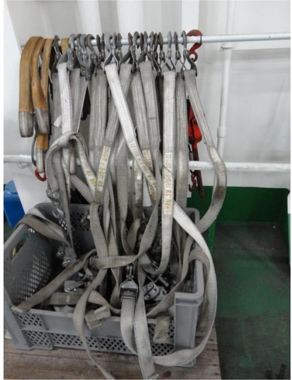
写真 2.6 使用されていた固縛資材
