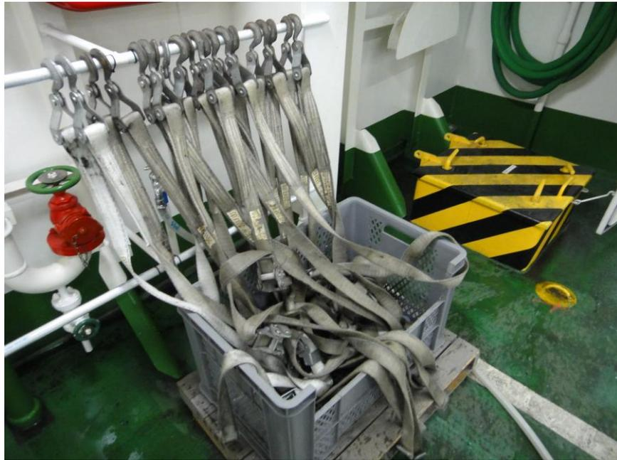
写真5.5 スリング幅45mmのベルト式固縛機 (ロックナー)
