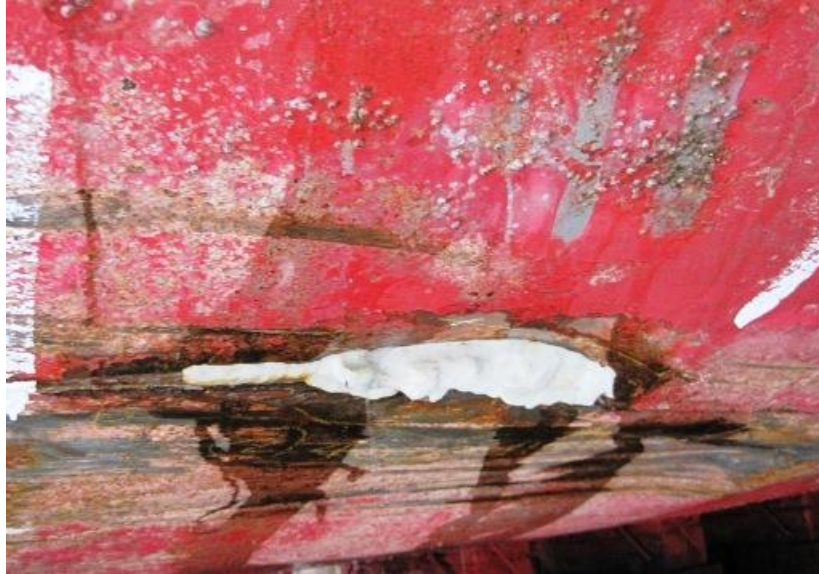
写真2 ビルジキール（右舷）の損傷状況
