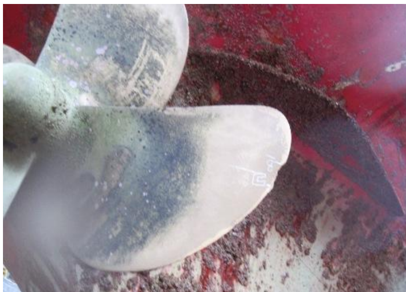
写真3 プロペラの損傷状況
