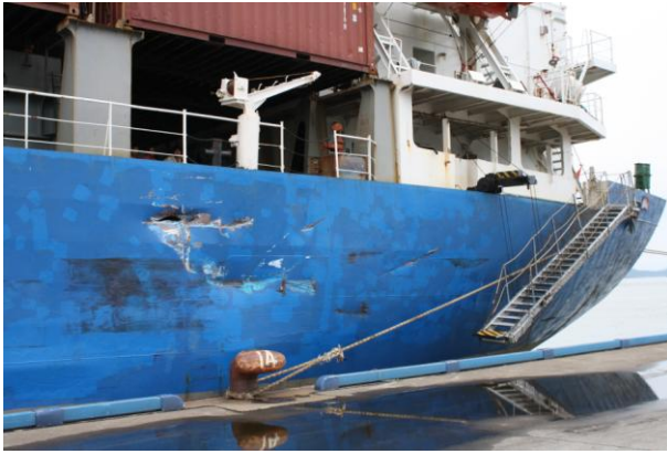
図2.3-1 A船の損傷の状況
