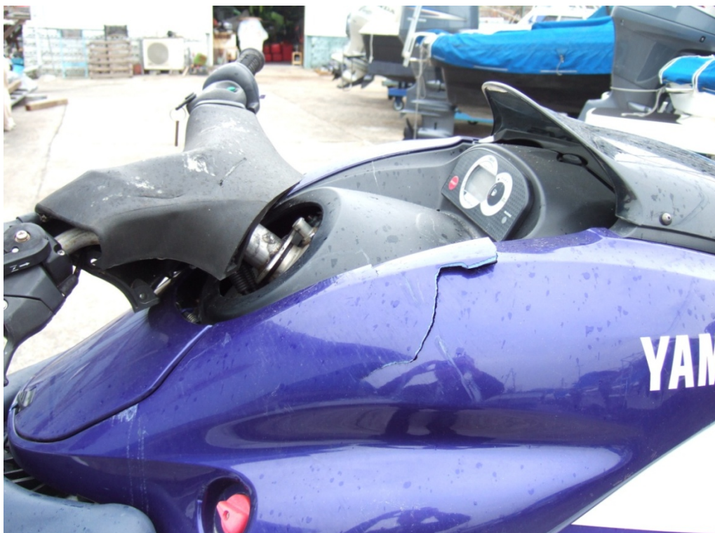
写真4 B船損傷部
